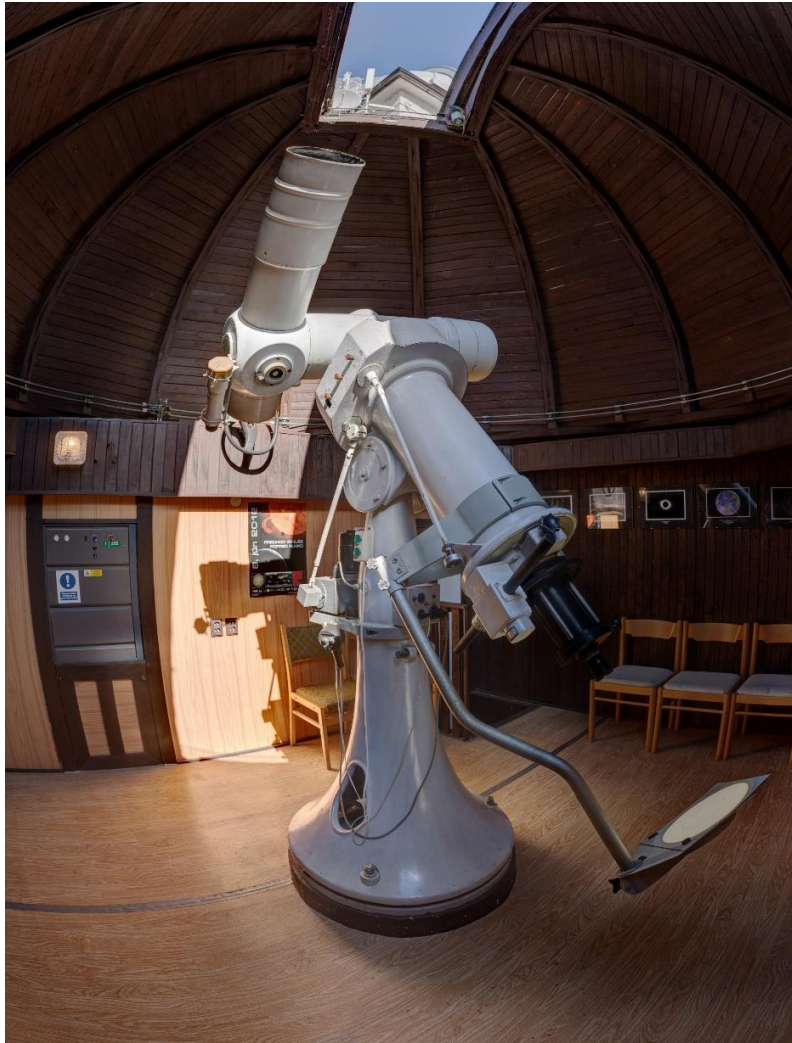
Zeiss Coudé refraktor 150/2250 mm a fotoszféra észlelésére kivetítéssel. A rektaszenciós tengelyre van felszerve a kivetítőlap.
