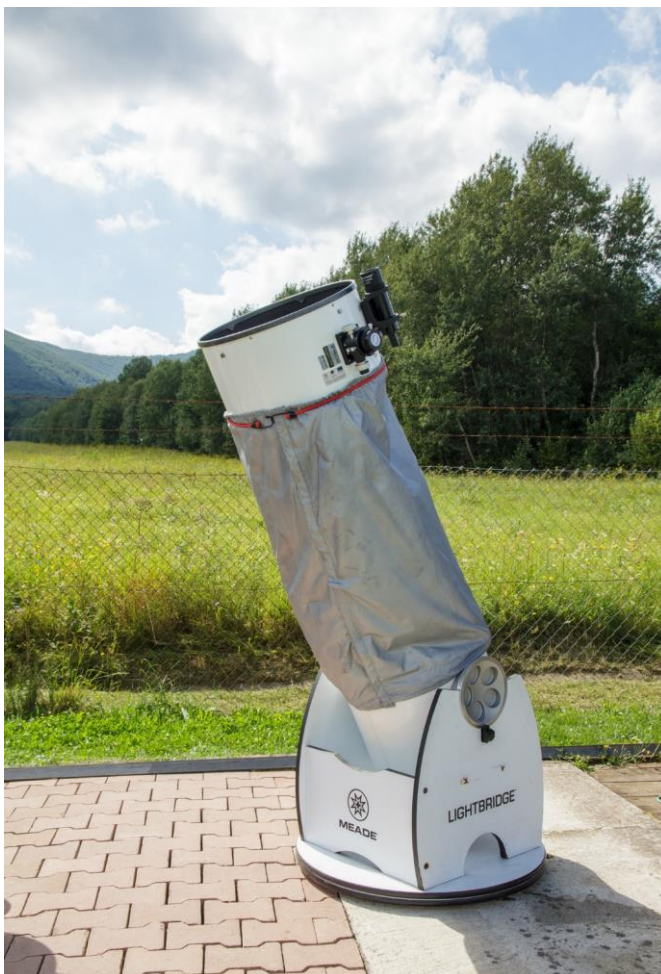
A Meade Dobson 406/1829, F4,5 fényerejű, hordozható távcső
